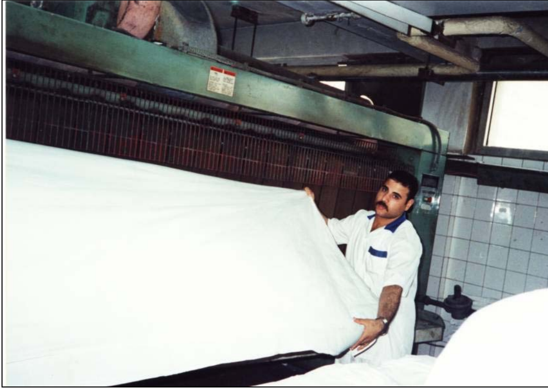
شكل رقم (٣ - ٦) : ماكينة الجندرة المستخدمة في كي ملاءات الغرف بقسم المغسلة
